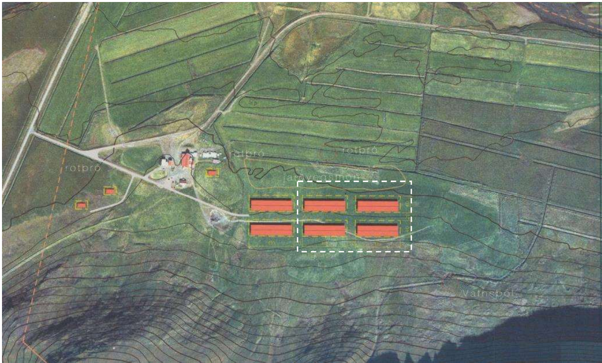
MYND 2.2 Fyrirhugað framkvæmdarsvæði að Hurðarbaki, austan við núverandi eldishús (Arkitekt og Ráðgjöf ehf. 1999). Ný hús eru afmörkuð með hvítri brotalínu, en gular brotalínur sýna byggingareiti skv. deiliskipulagi. Framkvæmdin fellst í uppbygginu á fjórum eldishúsum, staðsettum lengst til hægri á mynd, en húsin tvö lengst til vinstri eru þau sem fyrir eru í dag. Gert er ráð fyrir að húsin verði minni en þessi sem sýnd eru á deiliskipulaginu (4).
